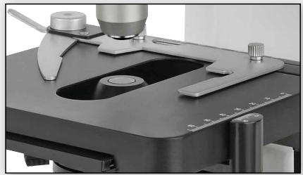
Koaxialer Kreuztisch mit Nonius Coaxial mechanical desk with Vernier scale
