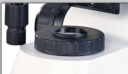
Blende für Köhlersche Beleuchtung Diaphragm for Köhler-illumination
