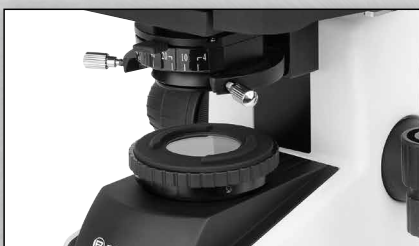
Abbe-Kondensator mit Blendenindikator und Köhlersche Beleuchtung Abbe condenser with aperture indicator and Köhler illumination
